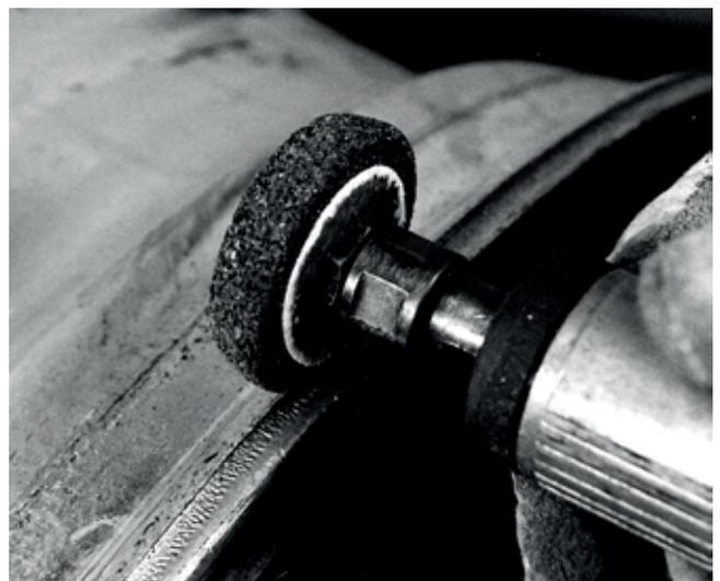
Illustration 13-32 Meuleuse à air comprimé ou électrique
